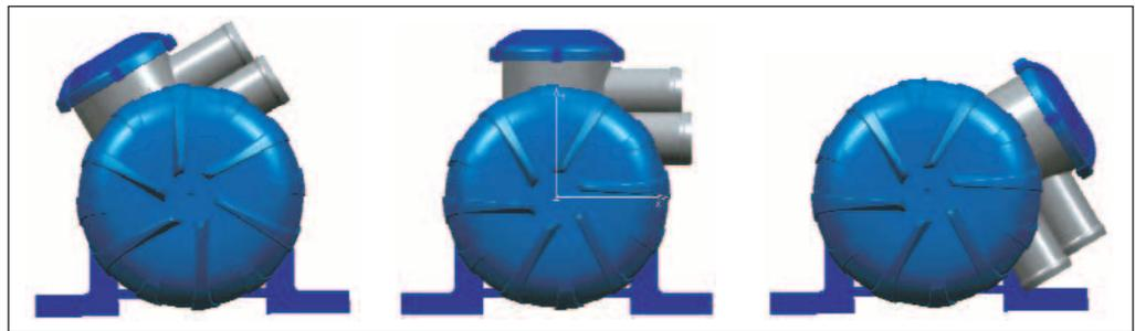
Figura 5: Vista desde arriba del cárter con diferentes posiciones del tubo
