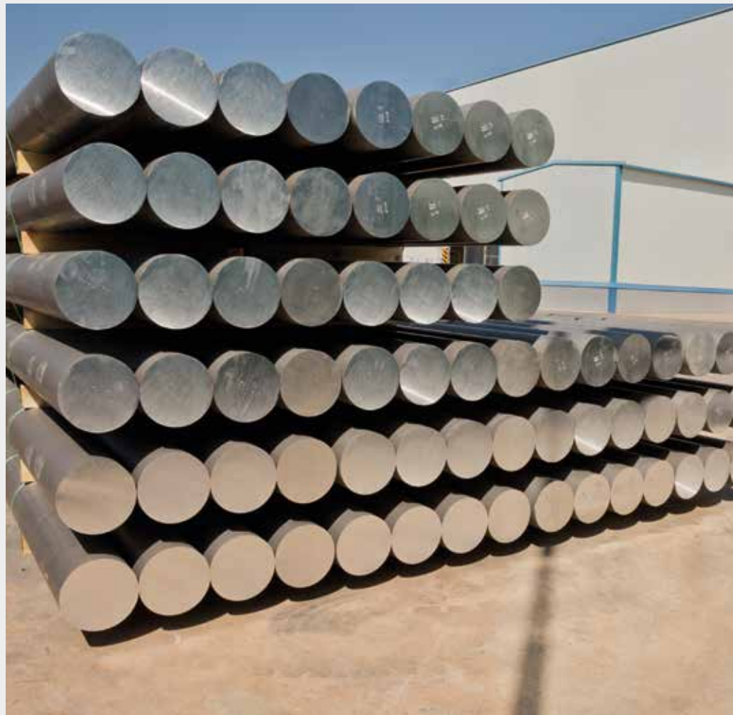
Lingotes cilíndricos también llamados “tochos”, para obtener perfiles de aluminio rectos y eliminar cualquier tensión en el material, se les estira. Luego, se cortan en longitudes adecuadas y se envejecen artificialmente para lograr la resistencia apropiada.
